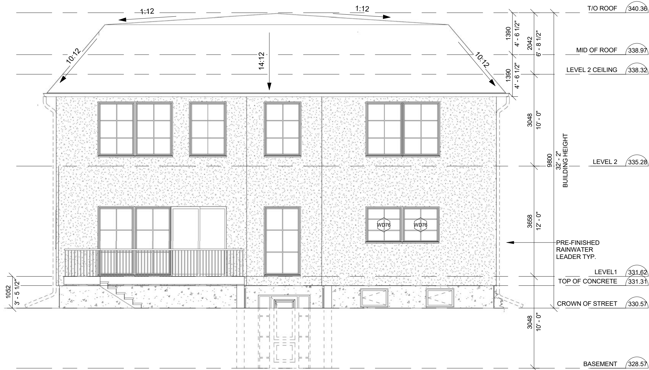
1 A403 North Elevation SCALE: 1 : 75
